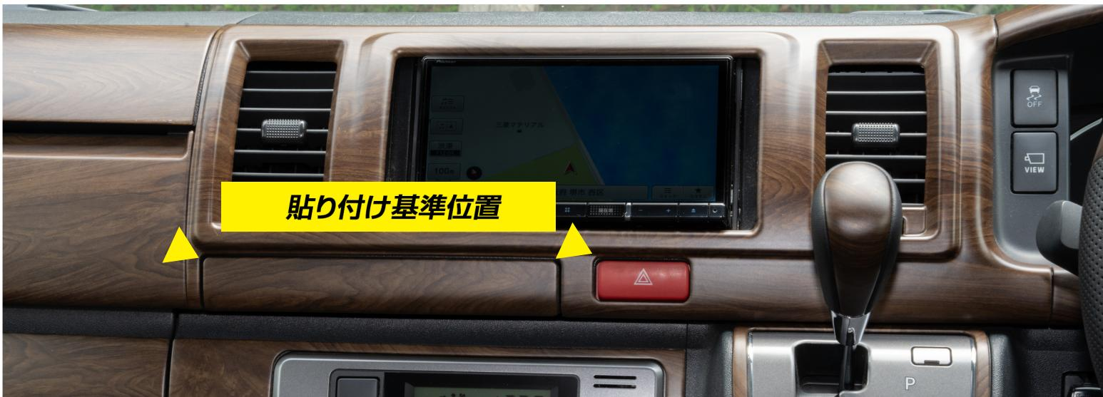
センターナビパネル部分のパネルの貼り付けを行う場合は、図中▼の位置(ドリンクホルダー部分)を基準に貼り付けを行ってください。運転席もしくは助手席側を基準に貼り付けを行いますと、ドリンクホルダー部分にズレが発生し、ドリンクホルダーパネルへ干渉が発生する場合がございます。
