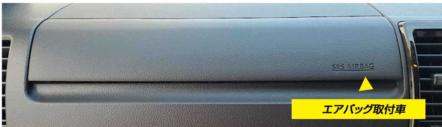
助手席側アッパー ボックス部分がエアバッグ(AIRBAG)となっている車両につきまして弊社アッパー ボックスパネルを貼り付けますと、エアバッグ作動時にパネルが飛散する可能性がございます。エアバッグ付の車両に貼り付けを行わないか、助手席側エアバッグが作動しないように処理を行ってから貼り付けを行ってください。
